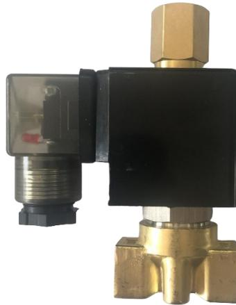
Válvula solenoide SINTEK modelo VSBAA-08 , diseñada para controlar el paso de fluidos y gases, principalmente aire y agua, su función básica es la apertura o cierre de la válvula por medio de una señal eléctrica. Una vez pasa corriente eléctrica a través de la bobina, acciona el mecanismo de la válvula y de esta manera deja pasar o bloquea el fluido o gas, según la necesidad del proceso industrial.
