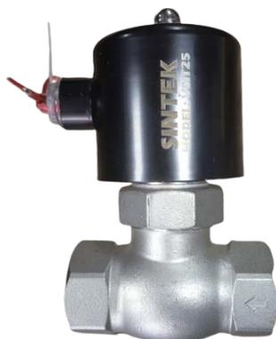
Válvula solenoide SINTEK INOX, diseñada para controlar el paso de fluidos y gases, su función básica es la apertura o cierre de válvula. Esto sucede cuando pasa corriente eléctrica a través de la bobina, accionando el mecanismo de la válvula y de esta manera dejando pasar o bloqueando el fluido o gas, según la necesidad del proceso industrial.
