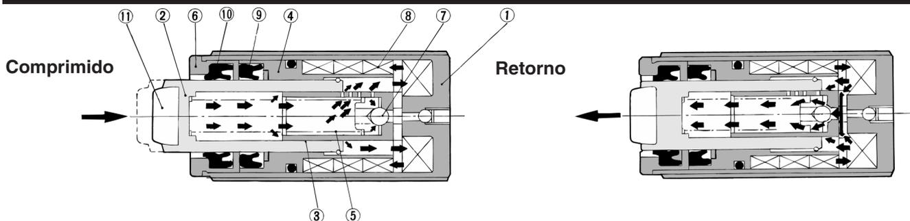
El objeto de impacto que choca contra el extremo del vástago del émbolo introduce aceite a presión dentro del émbolo. De esta manera, el aceite presurizado sale expulsado a través de los orificios que están dentro del émbolo. El aceite expulsado a través de los orificios es recogido dentro del tubo exterior mediante la función de estiramiento del acumulador.
