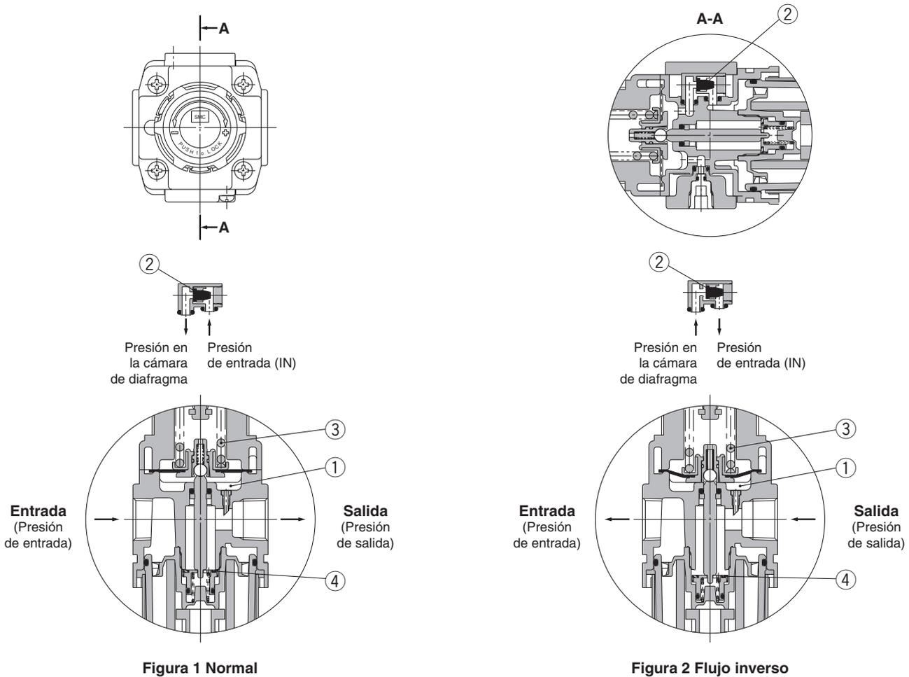
Cuando la presión de entrada supera la presión de regulación, la válvula ② se cierra y funciona como un regulador normal (figura 1). Cuando la presión de entrada se cierra y se evacua, la válvula antirretorno ② se abre y la presión de la cámara de diafragma ① se evacua hacia el lado de entrada (figura 2).
