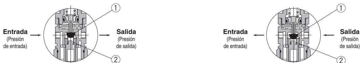
Cuando la presión de entrada supera la presión de regulación, la válvula antirretorno funciona como un regulador normal (figura 1).
