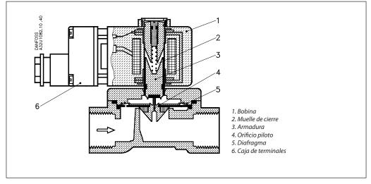
La regulación proporcional de la apertura y cierre de las válvulas EV260B se alcanza mediante la regulación progresiva de la corriente de la bobina y de la fuerza de conexión de la bobina.
