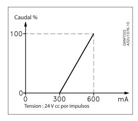
Modelo de bobina BM Con generador de señales y señal de control de 0-10 V El ratio entre la señal de control y el caudal es directamente proporcional en el rango de regulación.
