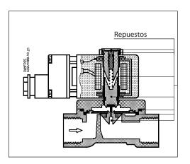
El kit de repuestos contiene p.ej. un botón de bloqueo y una tuerca para la bobina, armadura con clapet, muelle, juntas tóricas y diafragma.
