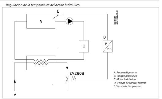
Para controlar la viscosidad y el rozamiento, es importante mantener una temperatura constante del aceite en el motor hidráulico (C). La refrigeración es por lo tanto necesaria regularmente.
